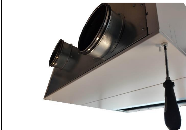
3) Svitare le due viti del pannello inferiore verso espulsione/estrazione aria
