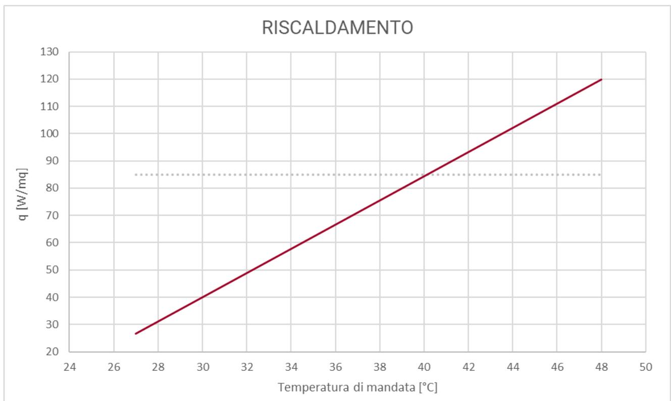
Figura 2 Resa in riscaldamento al m<sup>2</sup> di superficie attiva impianto radiante a soffitto, considerando  $\Delta\theta$  ( $T_{mandata}-T_{ritorno}$ )= 2 °C e  $T_{ambiente}$ = 20°C. La linea tratteggiata indica il limite specifico di emissione riferito a locali con altezze inferiori ai 2,7 m al fine di non creare situazioni di disagio, così come indicato al punto 4.2.1.4 della EN 1264-3:2021.
